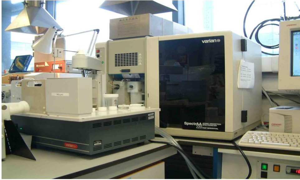
الشكل (1): جهاز الإصدار الطيفي في اللهب
