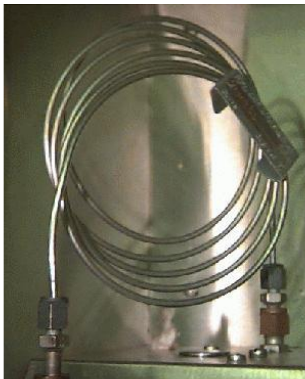
الشكل (2): يوضح العمود المعبأ في الكروماتوغرافيا الغازية
