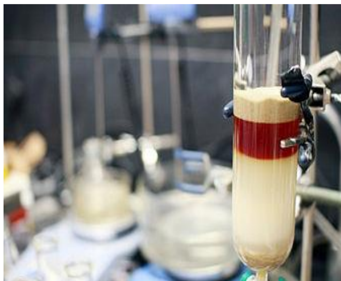
الشكل (1): يوضح العمود الكروماتوغرافي التقليدي
